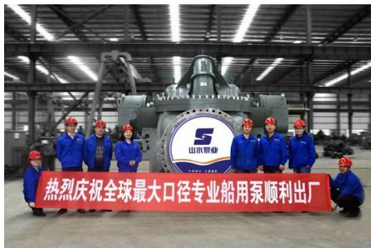
作为一家专业从事流体系统节能服务和流体节能装备制造制造的集团化公司，湖南山水节能科技股份有限公司（简称“山水节能”）一路高歌猛进。2016年4月16日，山水节能一台重量达 76 吨的砂泵成功出厂，成为我国乃至全球最大口径的专业船用泵。山水节能制造的全球首台最大砂泵，流量即输水量为 18000m<sup>3</sup>/h，即一个小时吸入的水可以填满 12 个体积为 1500 立方米的普通游泳池，扬程可达 145 米至 160 米。叶轮外径 2.38 米，转速达 410rpm，叶轮单件重量 6.7 吨，水泵单件重 41 吨，整体水泵重量高达 76 吨。全球首台高流量、高扬程的专业级砂泵的成功出厂，是山水节能制造业务领域的又一历史性突破，标志着山水节能在流体领域节能设备制造能力率先达到国内领先水平。
